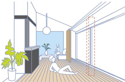
開口部を拡大（柱の移動や梁の補強）
